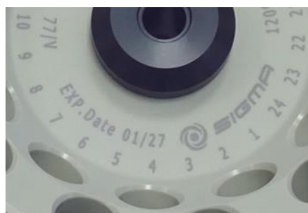
Fig.6 : Indication de la durée de vie spécifique sur une nacelle ou un rotor
