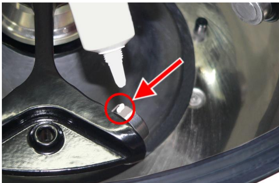
Fig. 38 : quantité suffisante de graisse pour un support de rotor
