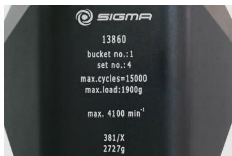
Fig.6 : Indication de la durée de vie spécifique sur une nacelle ou un rotor
