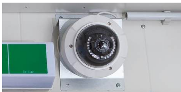
Surveillance vidéo et enregistrement de la zone de danger à l'intérieur ou à l'extérieur
