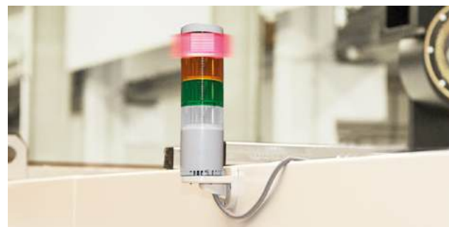
Lampe de signalisation pour l'indication visuelle d'une alarme
