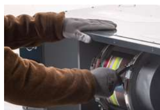
3 Monter le filtre à charbon actif, le fixer et fermer la face avant du boîtier
