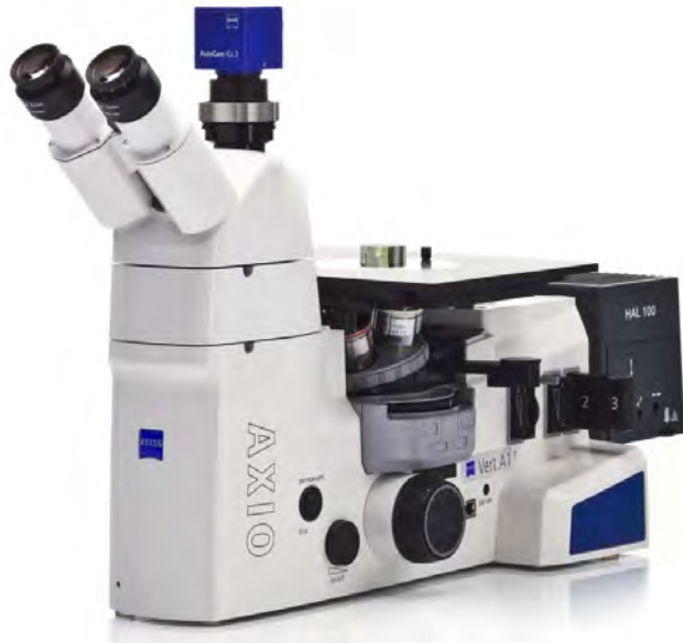
Sortie photo latérale pour dégager l'accès à la platine
