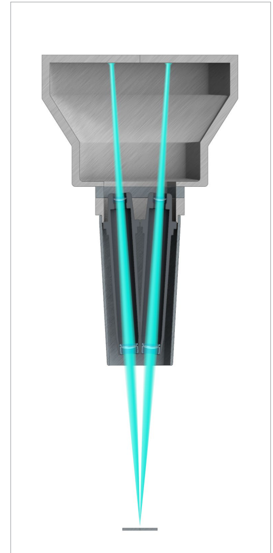
Trajet schématique des faisceaux d'un microscope stéréo de type Greenough.
