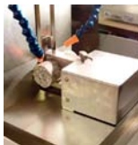
Étau pneumatique pour découpe de carotte sur T260 double lame
