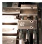
Étau gauche à serrage rapide hauteur 45 mm Réf. 50905
