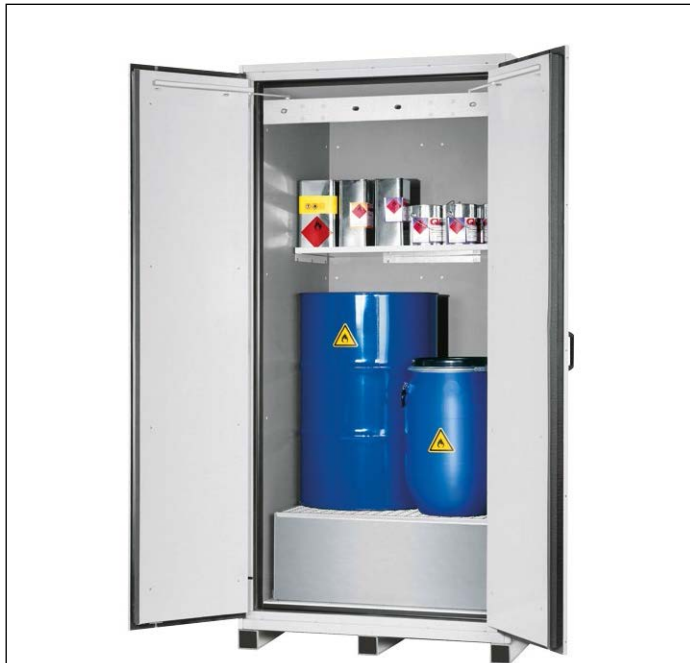
Armoire de sécurité XL-CLASSIC-90 modèle XL90.222.110.WDAS en gris clair (RAL 7035), équipée avec 1 x étagère (tôle d'acier revêtue époxy), 1 x socle de transport (acier revêtue époxy), 1 x bac de rétention au sol avec caillebotis (tôle d'acier galvanisé) Code article 30393-001-30397
