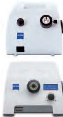
Eclairage en lumière réfléchi avec fibre optique reliée à une source froide
