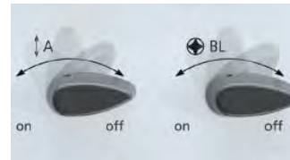
Mise en place très simple de l'analyseur ou de la lentille de Bertrand
