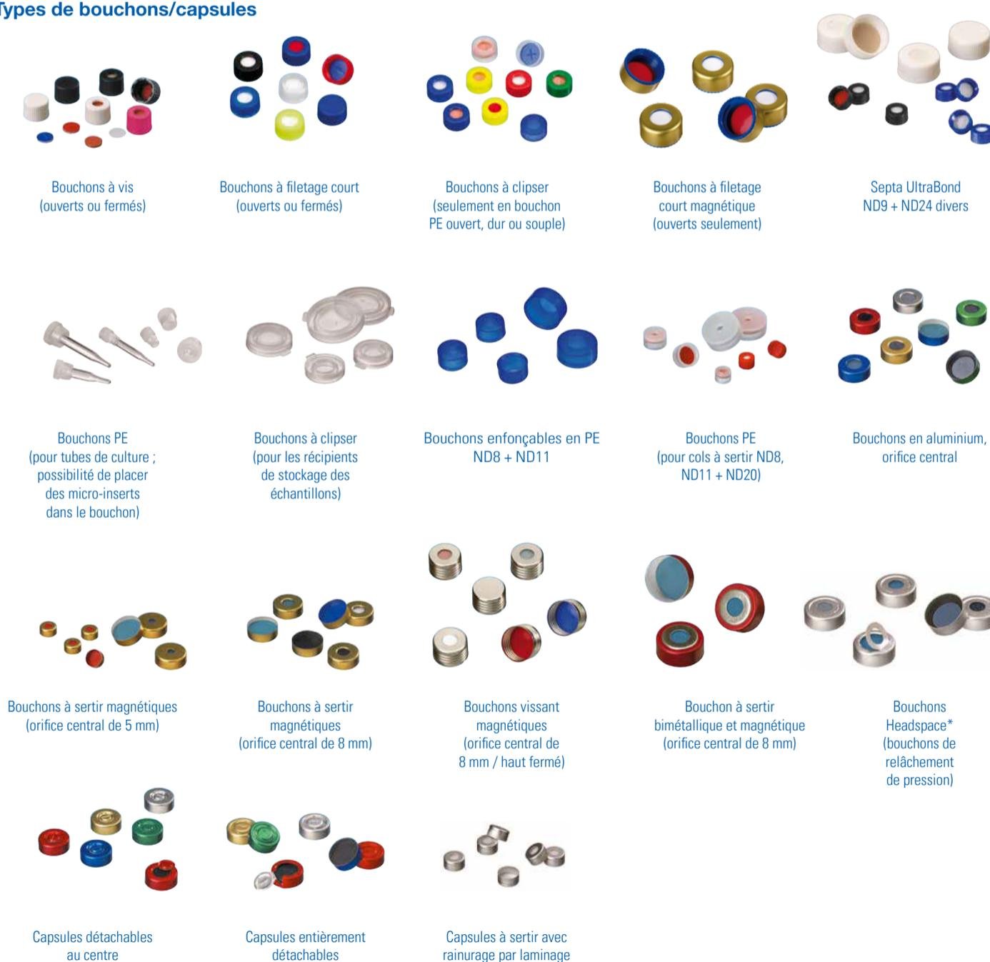
\*Un bouchon Headspace est un bouchon de sécurité qui permet d'éviter que le vial explose en cas de pression interne trop élevée. Ce type de bouchon est doté de lignes de repère spéciales avec des ponts qui s'ouvrent lorsque la pression interne est comprise entre  $3,0 \pm 0,5$  bar. Ceci permet de libérer l'excès de pression et d'éviter que le vial explose.
